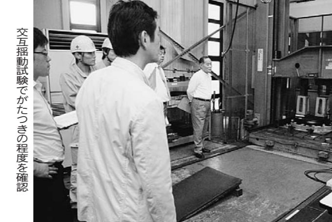
交互振動試験でがたつきの程度を確認
